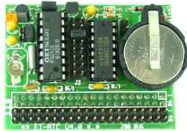
ภาพที่ 1.2 แสดงการใช้แบตเตอรี่สำรองไฟให้กับไอซีหน่วยความจำ
