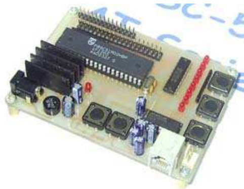
ภาพที่ 5.14 บอร์ดใช้งานไอซีไมโครคอนโทรลเลอร์ MCS-51 ขนาด 40 ขา
